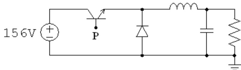
**27.** Os componentes do conversor BOOST da figura apresentada foram dimensionados para que ele funcione em condução contínua. O sinal PWM “P” que aciona o transistor tem um DUTY CICLE (ciclo de trabalho) de 40%. De posse dessas informações e considerando os semicondutores ideais, calcule a tensão no resistor de saída do conversor e marque a opção correspondente.
