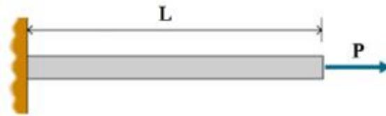
Considerando que a barra seja fabricada com um material de Módulo de Elasticidade  $E$ , podemos afirmar que o deslocamento sofrido pela extremidade livre da barra será o mesmo se a barra for substituída por uma mola, sujeita às mesmas condições de fixação e carregamento, com constante elástica (rigidez)  $K$  igual a:
