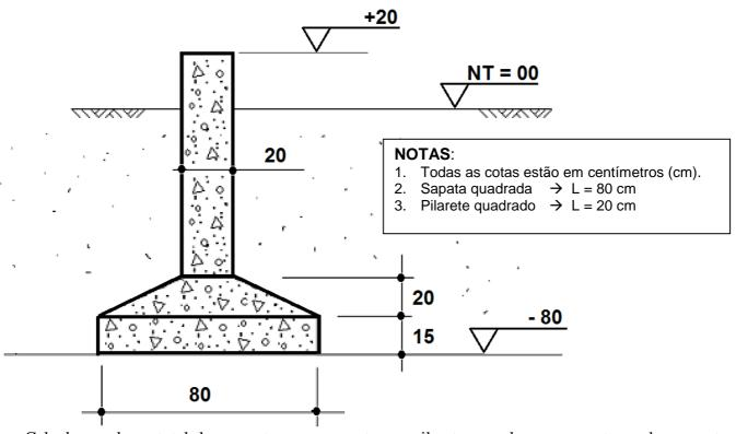
Calcule o volume total de concreto para a sapata e o pilarete, sem levar em conta o adensamento e/ou as perdas.
