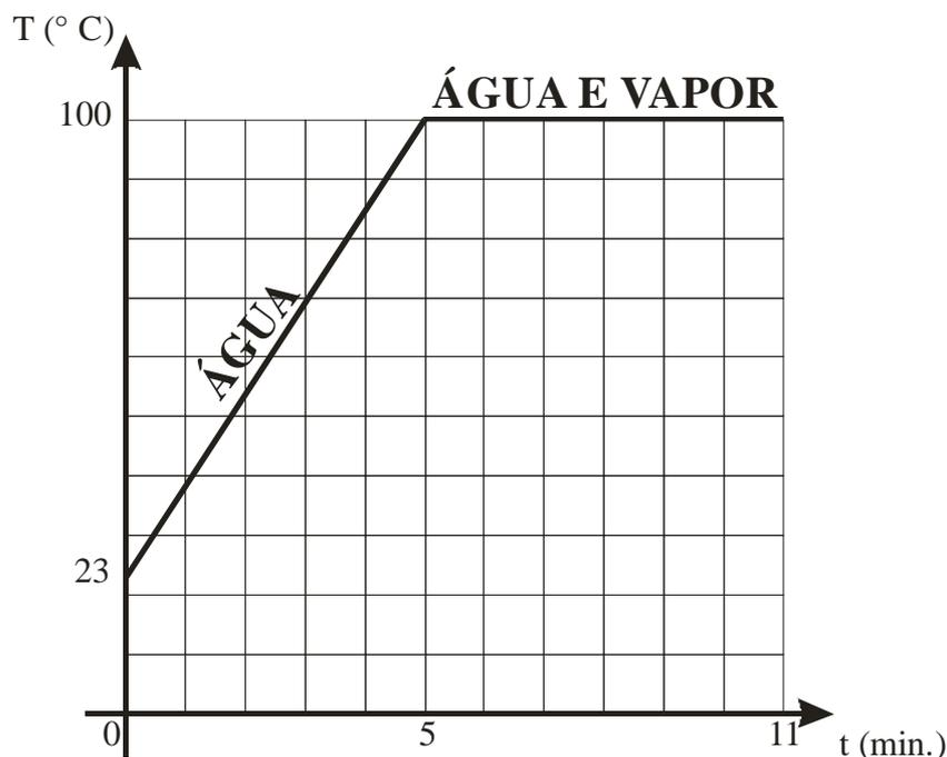
Nos 5 primeiros minutos a água é aquecida de  $23^{\circ}\text{C}$  a  $100^{\circ}\text{C}$ . Nos 6 minutos restantes a água ferve e começa a se transformar em vapor.
